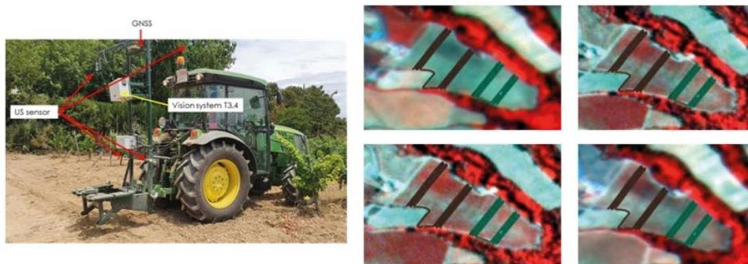
*Figura 8. Dispositivo desarrollado provisto de sensores ultrasónicos para mediciones de dosel en campo (derecha); resultados obtenidos después de mediciones en campo comparados con imágenes satelitales para determinar la relación óptima (izquierda).*
