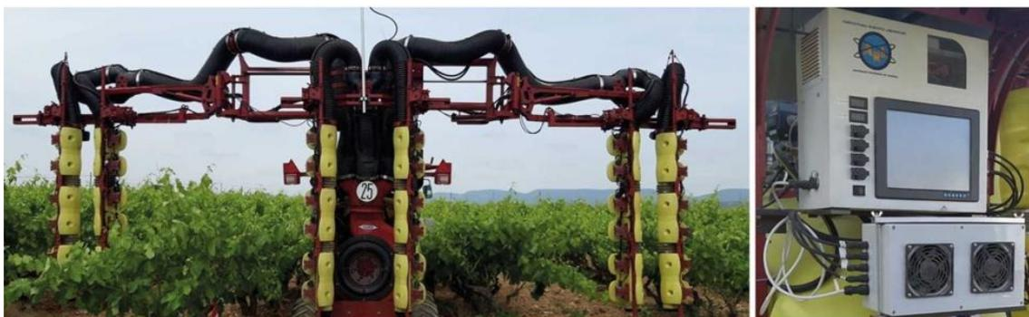
*Figura 6. Imagen general del pulverizador multifila inteligente para viñedos durante una aplicación (izquierda) y detalle del ordenador para interpretación de mapas y control de pulverización (derecha).*
